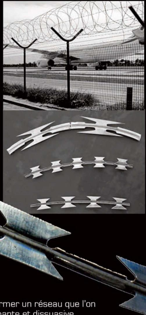
En réseau : Cette bande est enroulée en cercles concentriques pour former un réseau que l'on peut déployer (comme un accordéon) afin d'obtenir une barrière tranchante et dissuasive (réseau). Les spires sont agrafées entre elles par une agrafe acier plate. Ancrée en queue d'aronde, elle ne peut être rompue ni à la main, ni avec des outils ordinaires.
